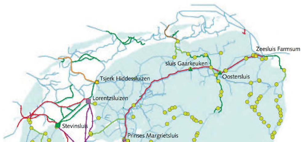
Figuur 3-4 Vaarwegenkaart naar bevaarbaarheidsklasse (Rijkswaterstaat, 2008). Na 2008 heeft de drempelverwijdering in de Boontjes plaatsgevonden, waardoor deze bevaarbaarheidsklasse van de Boontjes is gewijzigd.
