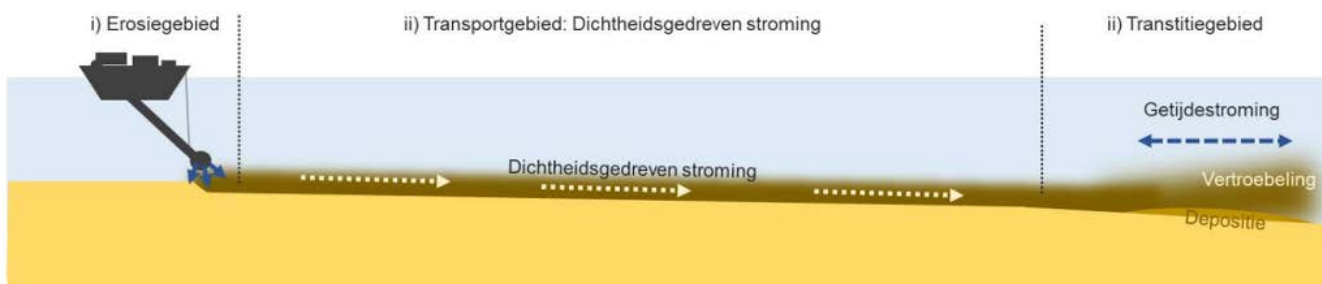
Figuur 3-11 Schematische langsdoorsnede van de drie gebieden die worden onderscheiden rond de dichtheidsstroom, die op gang wordt gebracht door het WID-en (uit Van Dijk & van der Baan, 2021).
